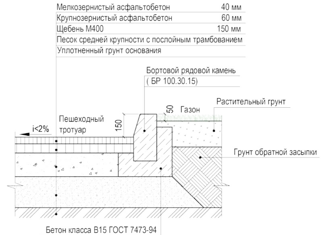
3.13.1 Схема устройства сопряжения асфальтобетонного покрытия и газона
