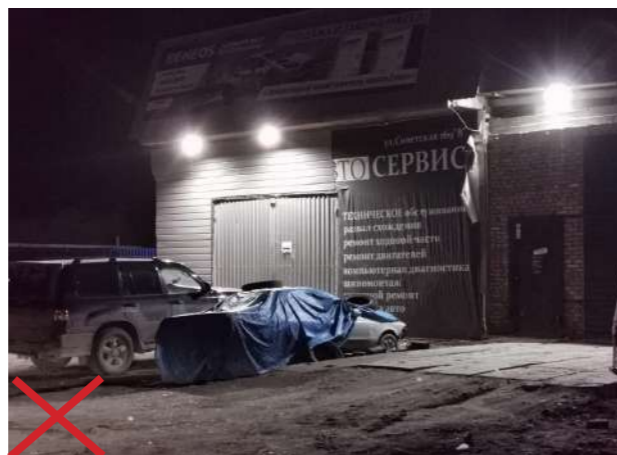
Недопустимо устанавливать светильники (прожекторы) со слепящим эффектом.
