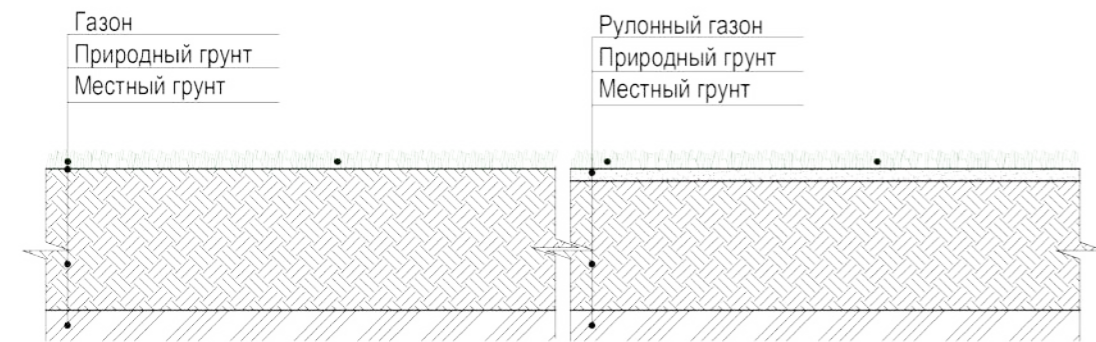
3.10 Схема устройства газона
