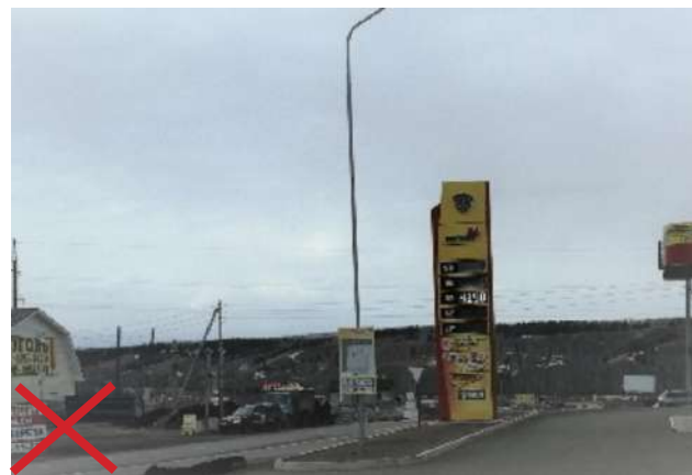
Недопустимо опоры освещения совмещать с рекламными вывесками и схемой движения на АЗС.
