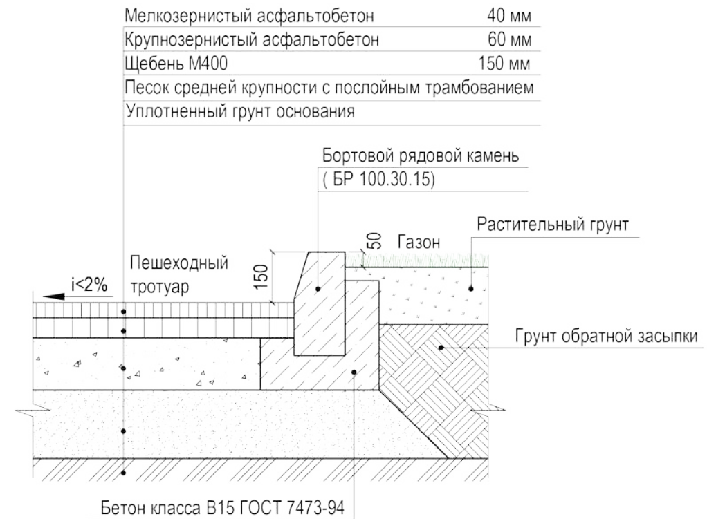
3.13.1 Схема устройства сопряжения асфальтобетонного покрытия и газона
