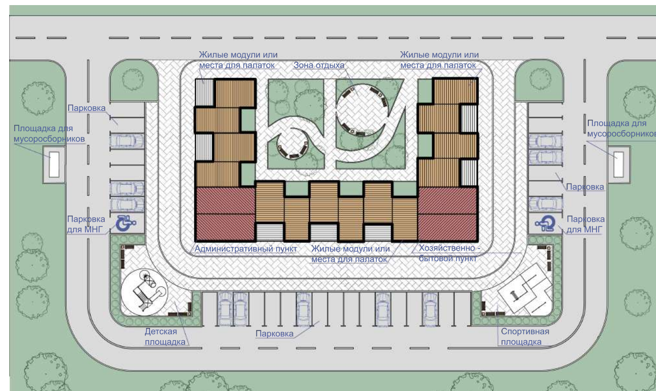
Планировочное решение (генплан): стандартная планировка
