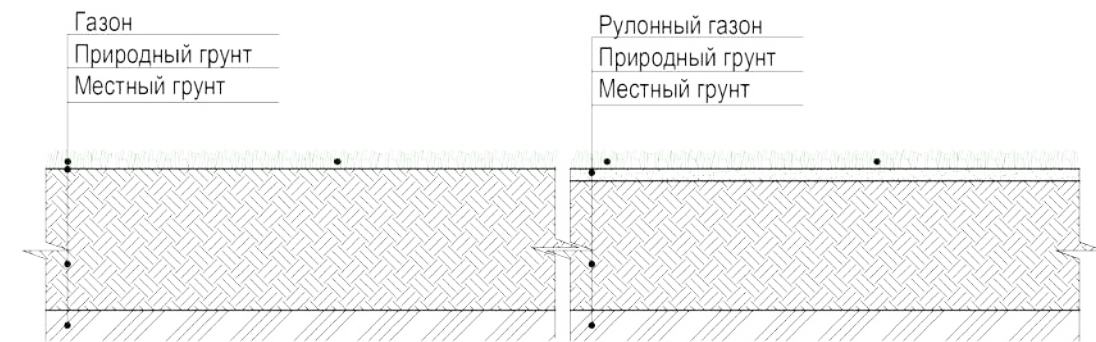
3.10 Схема устройства газона
